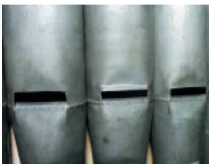
*Particolare delle bocche delle canne Bognini di Flauto. Il metallo è: Stagno 82,74%, Piombo 16,24%, Argento 0,23%, Rame 0,22%.*
