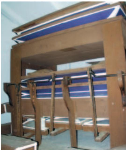
*Macchina della manticeria con mantice a lanterna, tipo Cummins, con tre pompe di caricamento rifatta nel 1912.*
