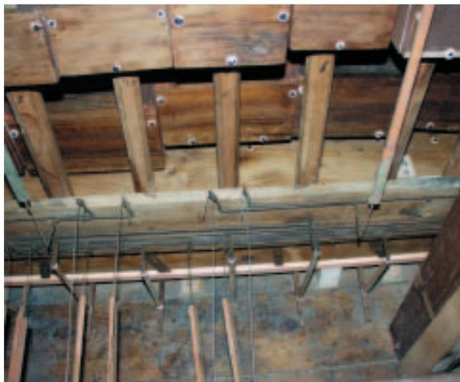
*Parte delle 40 canne di legno. Si notino: i piedi ottagonali tipici della scuola Bossi; i giochi delle meccaniche e i canali che portano l'aria con pressione di 52 mm in colonna d'acqua.*
